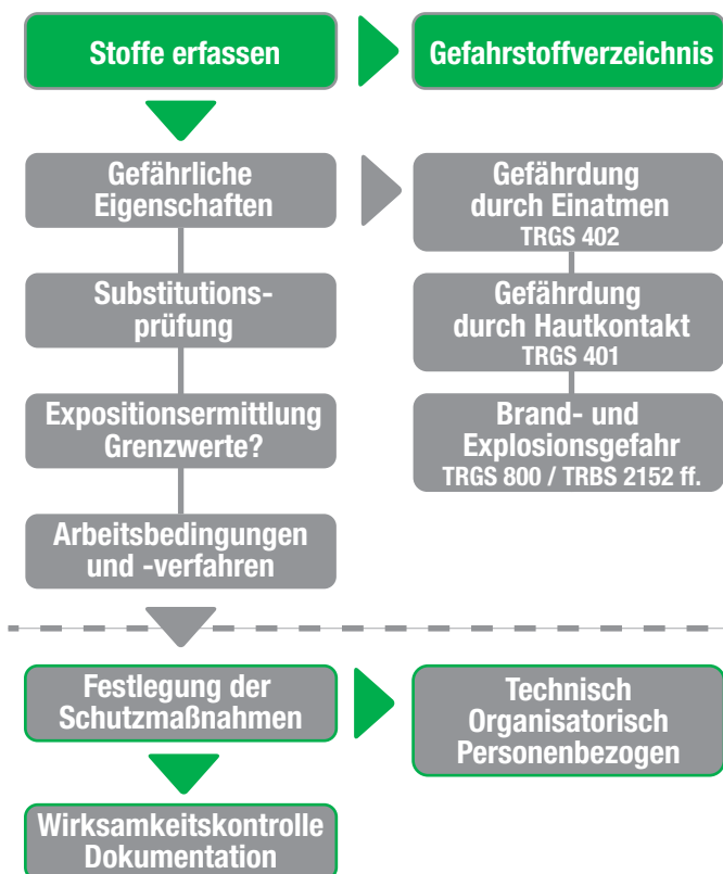
Abb. 1: Festlegung / Überprüfung der Schutzmaßnahmen vor Gefahrstoffen
