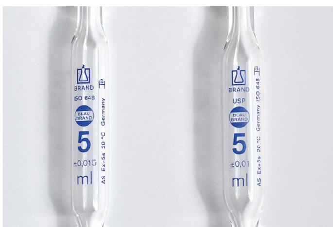
Abb. 3: 5 ml Vollpipette ISO (links) im Vergleich zur 5 ml Vollpipette USP (rechts).
