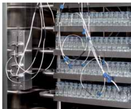
Abb. 8: Produktfühler in einer ca. 1 cm hoch mit Wirkstoff befüllten Rollrandflasche
