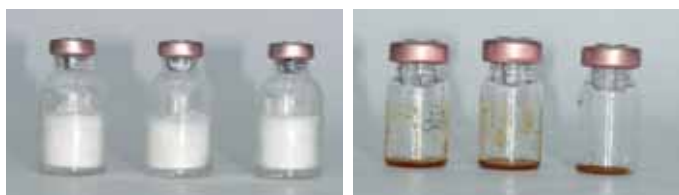
Abb. 6: Ordnungsgemäß getrocknetes Produkt (links) und angetautes verspritztes Produkt (rechts)
